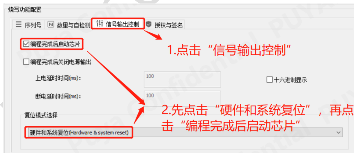
图 5-3 创芯工坊操作勾选“编程后重启芯片”
