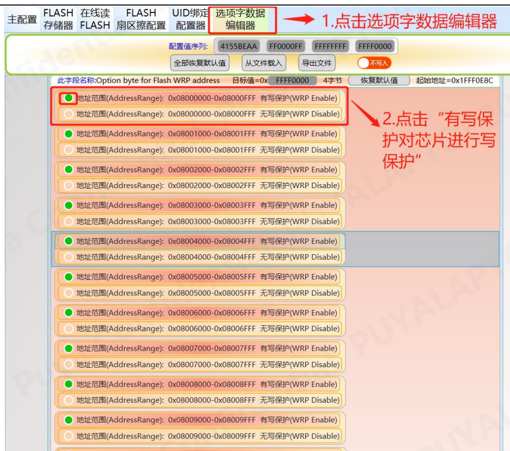
图 5-2 轩微操作 Option 写保护
